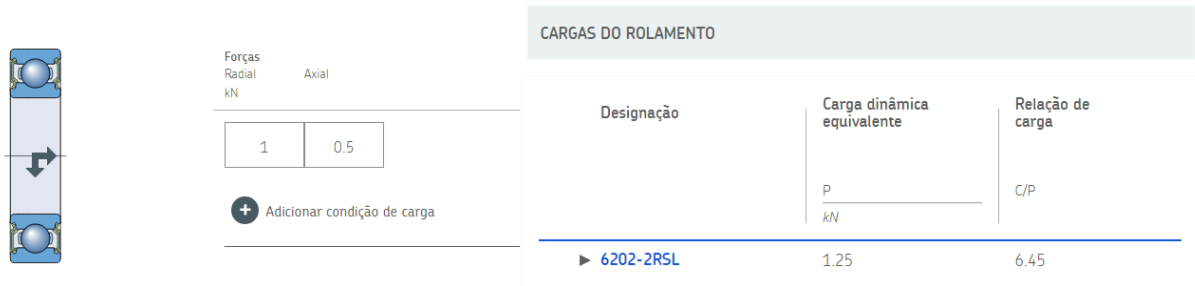
Figura 62: Validação dos rolamentos por meio da ferramenta SKF Bearing Select
