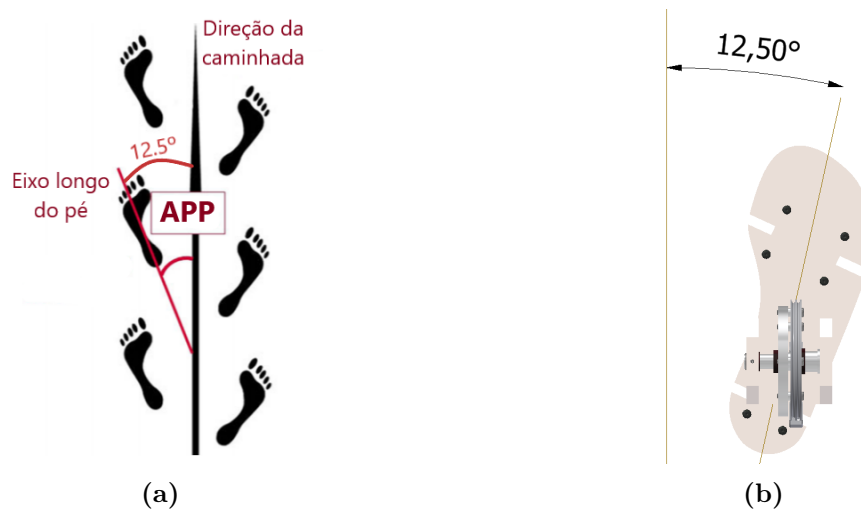
Figura 76: a) Dimensões do ângulo de progressão do pé segundo a literatura b) Dimensões do projeto mecânico do ângulo de progressão do pé
