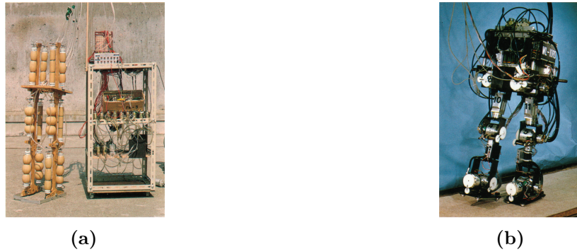
Figura 6: a) WAP-1, Robô bípede antropomórfico b) WL-10RD, Robô bípede antropomórfico com controle de torque
